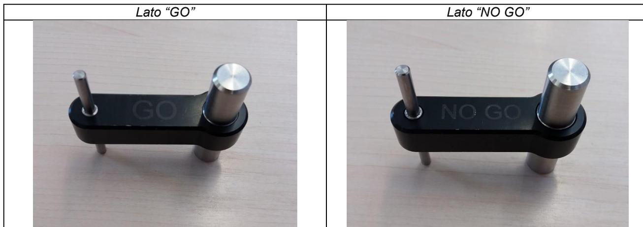
I 2 rulli della rotore, per essere correttamente tarati, devono essere in posizione tale da poter passare liberamente quando il rotore è inserito nel lato "GO" ed invece fermarsi contro il perno quando il rotore è inserito dal lato "NO GO".
