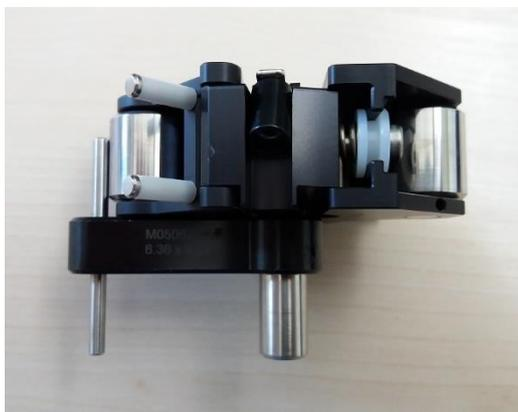
Dal lato "GO" dello strumento regolare la posizione dei rulli con la vite a brugola in modo che si trovino il più possibile vicino al perno ma comunque sempre liberi di muoversi.
